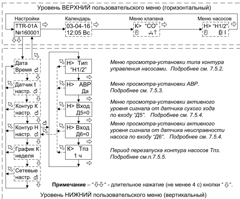
Рисунок 9 - Структура меню настройки параметров контура управления насосами.
