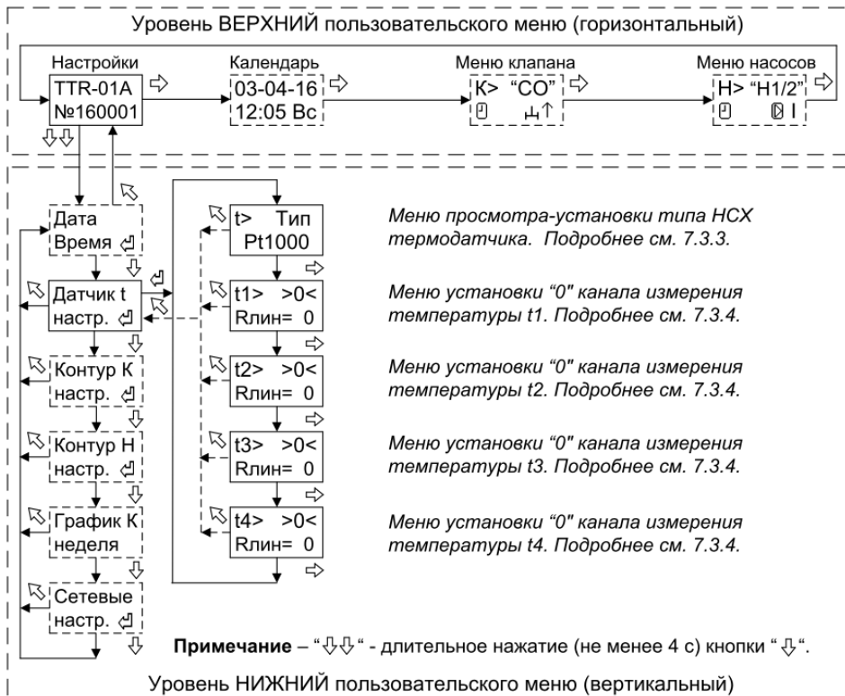
Рисунок 3 - Структура меню настройки канала измерения температуры
